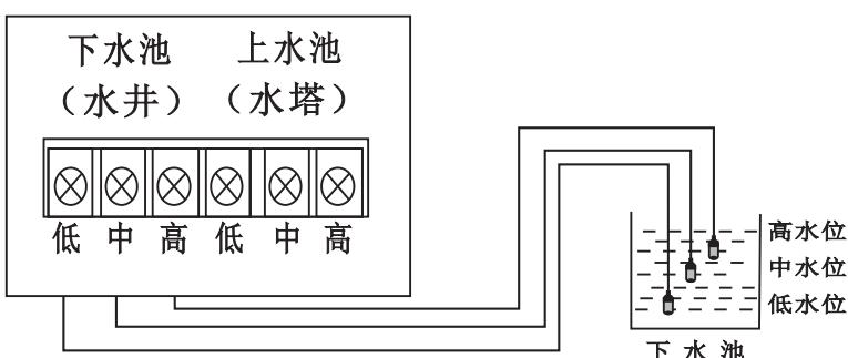
注:水满到高水位时会开始排水,一直排到中水位会停机,低水位讯号线起回路作用. (空载设置为00.0A)
