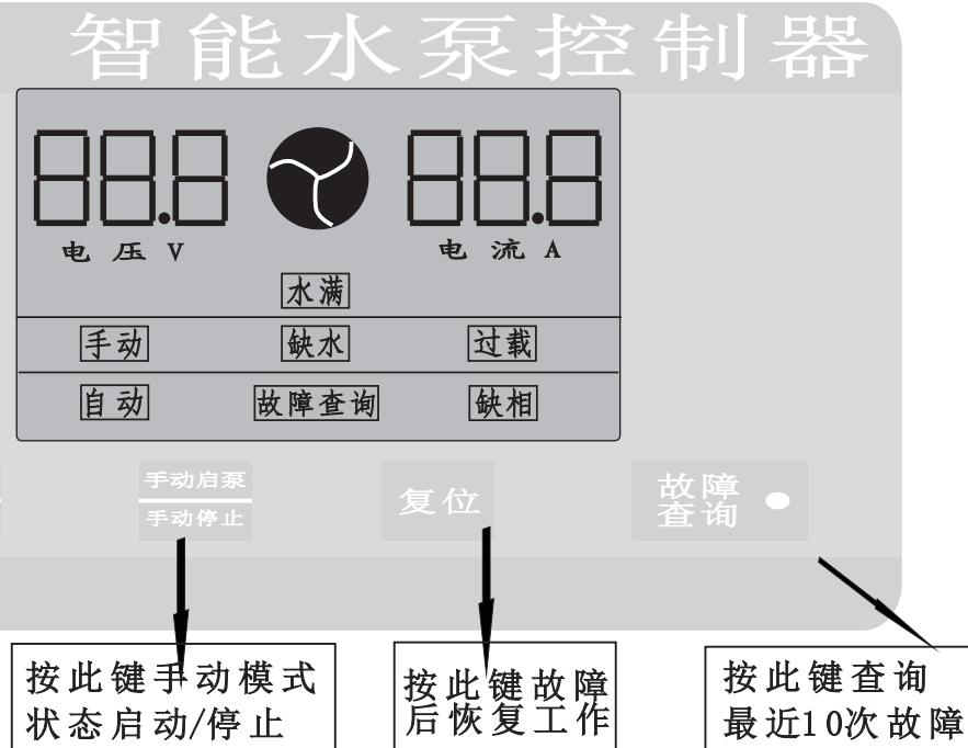
1、开机：连接好所有的线后，闭合空气开关，选择好工作模式，水泵即开机。
