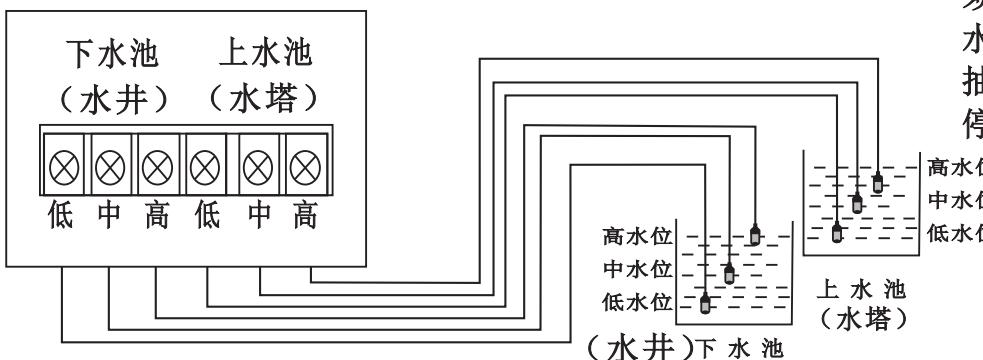
注:下水池用讯号线需跟厂家另行订购.空载保护必须设置为00.0A上水池的水用到中水位时会开始抽水,抽到高水位会水满停机.下水池满至高水位时会开始抽水,抽到中水位时会停机,即缺水保护,上、下水池之低水位讯号线都是起回路作用.
