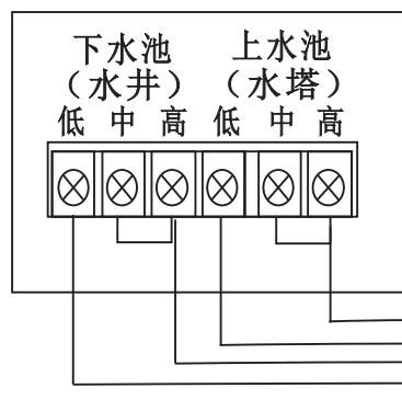
提示：浮球接法时，将水位的中位与高位短路(连接)，再将浮球常开的两根线分别接到低位和高位；常闭点不用接即可。
